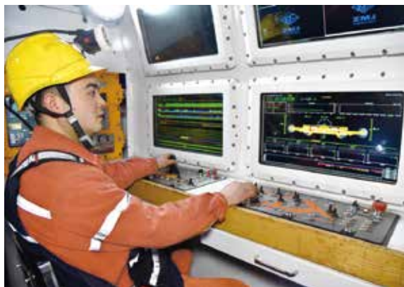
智能化工作面井下集控室
